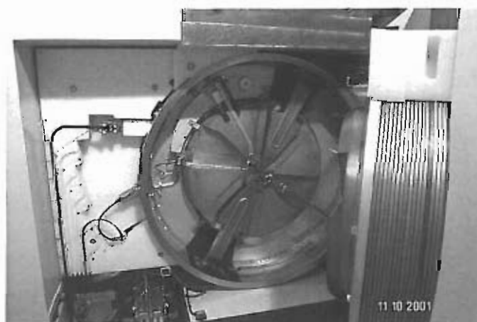
Figura: camera di accelerazione del ciclotrone
